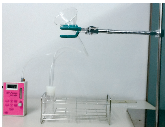
図 1. クラリセージ精油の香り発生・被験者へ送るための装置
